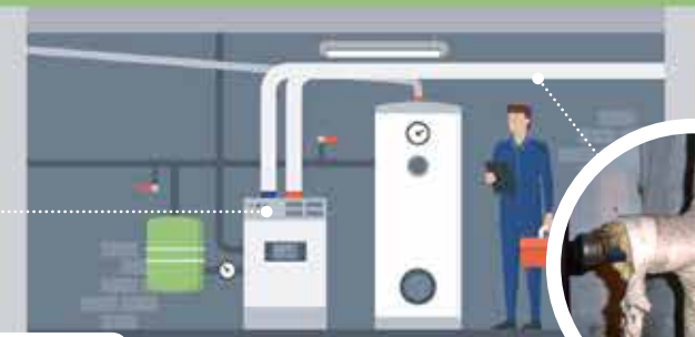
PLAASTERISOLATIE Brokkelig plaaster rond verwarmingsleidingen met weinig tot zeer veel vezels. Meestal omwikkeld met wit jute doek.
